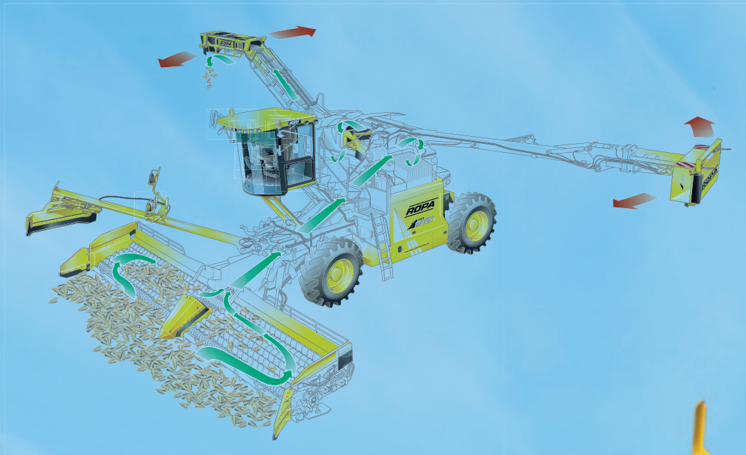
Двойной путь очистки на приемном столе - индивидуальная настройка потока очистки
