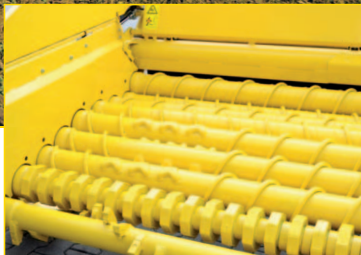
Независимые приводы трех групп вальцов с индивидуальной регулировкой скорости вращения и автоматическим реверсом при попадании камней
