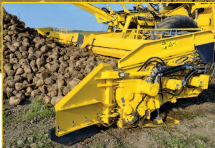
Независимые приводы трех групп вальцов с индивидуальной регулировкой скорости вращения и автоматическим реверсом при попадании камней
