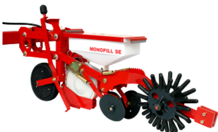
Стандартная высеваяющая секция с пальчиковыми уплотняющими катками
