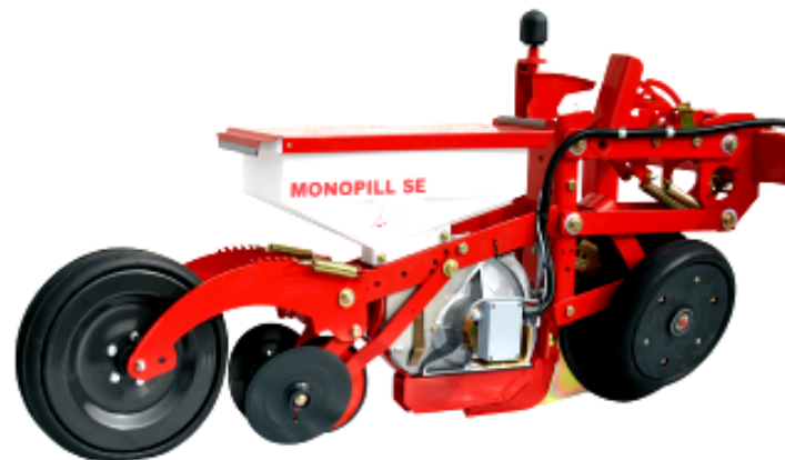
Мульчирующая высеваяющая секция с прикатывающими катками Monoflex
